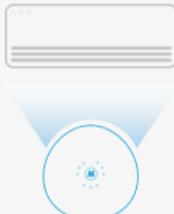
Positionieren Sie Melissa an einer freien Stelle gegenüber Ihrer Klimaanlage und sorgen Sie dafür, dass das Infrarotsignal nicht durch Gegenstände unterbrochen wird.
