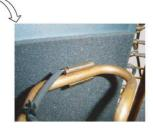
Remove the Thermistor(Discharge).
